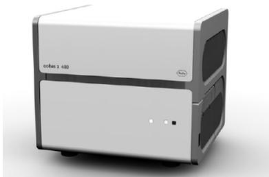
本装置は、本体、コントロールユニット(PC、ディスプレイ、キーボード、ハンディバーコードスキャナー、マウス)から構成されます。また、オプションでコントロールユニットにプリンターが接続できます。
