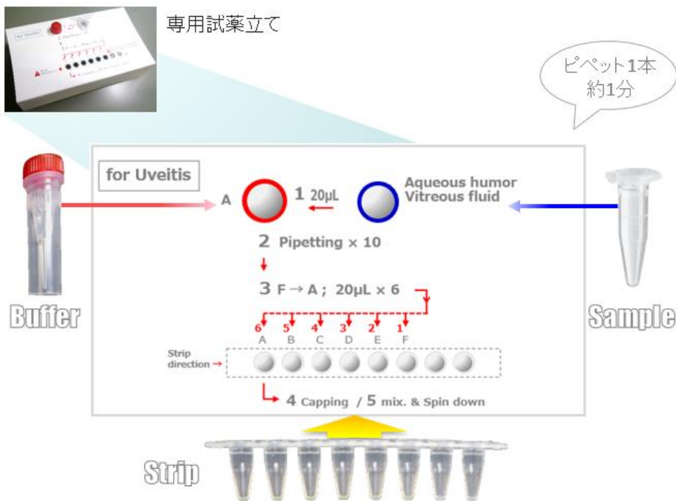
図5 試薬の使用法 専用試薬立てに試薬2種類と、検体チューブをセットして、指示通り進めるだけ（1分）
