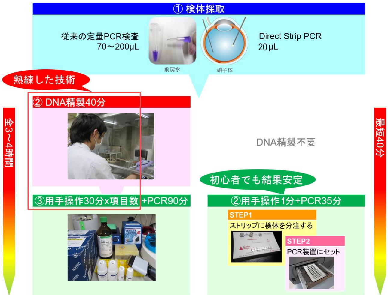
図4 従来の定量PCR検査とDirect Strip PCR検査の比較 検体量・時間・マンパワーの節約に繋がる
